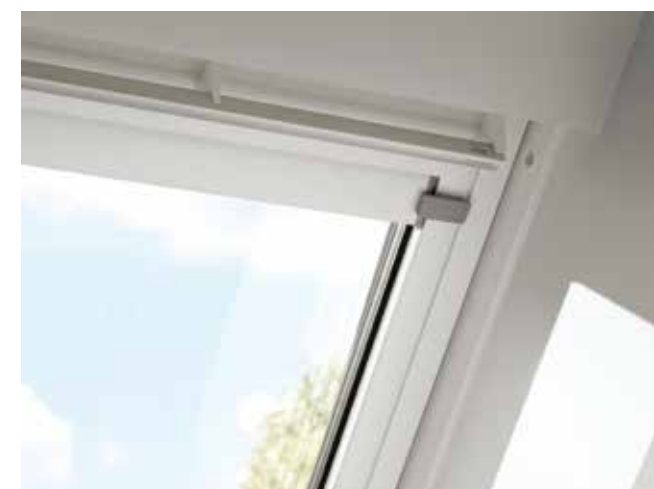
Das Ausfahrprofil mit Motorblock und Solarzelle wurde für eine schlankere Optik im Fenster bei eingefahrenem Sonnenschutz von 68mm auf 50mm Höhe reduziert.
